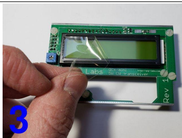
3 LCDモジュールから保護シートを剥がします
