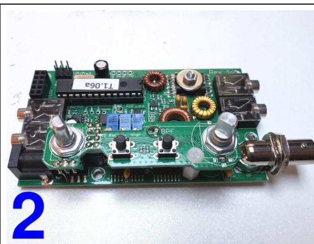
2 そして、コントロールボードが固定されたメイン基板
