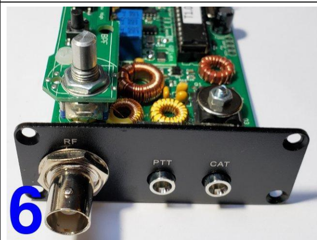
6 右側のサイドパネルをキットに入っているBNCのワッシャとボルトでメインボードに取り付けます
