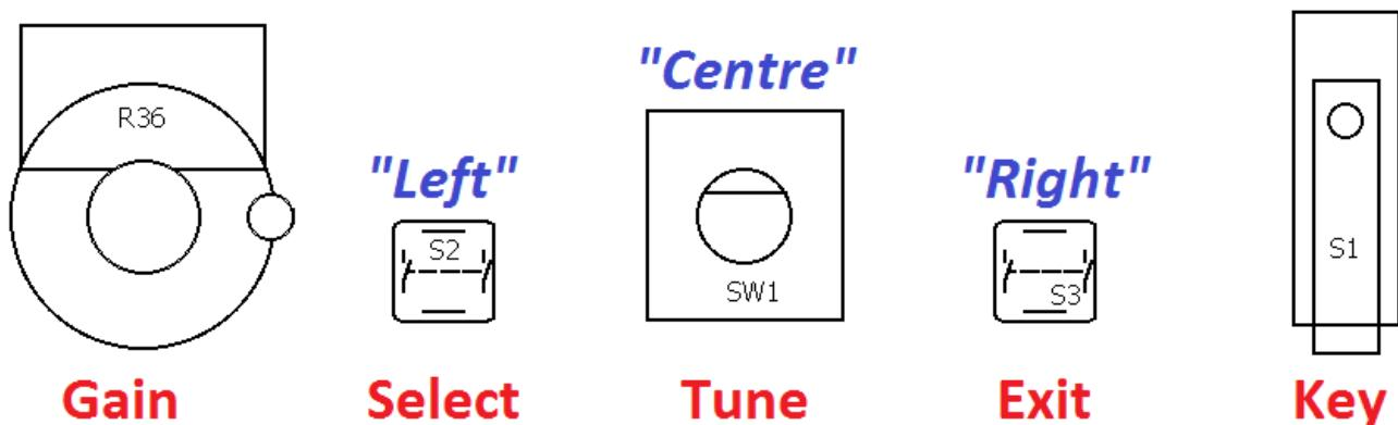
この図はリグの動作コントロールを示します。利得ボリュームを除いたコントロールはすべて、動作モードや、メニュー編集などに依存して、複数の機能を持っています。真ん中にある回転式のエンコーダはシャフトにボタンを持っていて、それを押すことによって作動します。このボタンはまた複数の機能を持っています。
