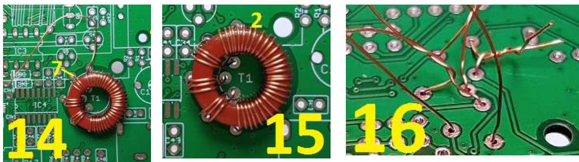
17) さて、これでPCBの下で8箇所の接続をはんだ付けすることができます。私は、1度に1組のワイヤをハンダ付けするように勧めます；こうすることで、他のワイヤが適所にトロイドを保持し、落下するのを防止してくれます。2つのねじられなかったワイヤで始めてください。
