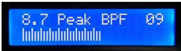
C1トリマーの調整は振幅バーの変化で知ることができます。この表示が最大になるようC1トリマーを調整します。これを行うことで、バンドパスフィルタのピークはバンドのCWセクションに集中するでしょう。
