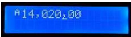
設定可能なVFOの調整レートは1kHz、500Hz、100Hz、または10Hzです。
