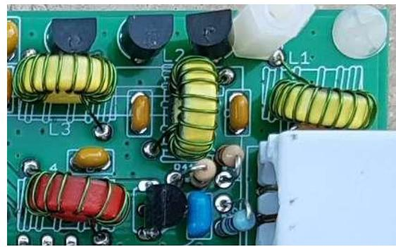
ワイヤをはんだ付けしようとしている間に、トロイドが落下しないように、穴を通したワイヤを曲げてください。PCBを通して突出しているワイヤを、ほんの2mm程度残して、余分なワイヤを切り取ってください。さあ、ハンダごてから十分にはんだを流し込んでいきます。数秒の間、接合する部分にハンダごてを当てます。私は通常10までゆっくりカウントすると、はんだはワイヤを取り囲むでしょう(それは、エナメルを焼き払うのに十分に熱くなるでしょう)。エナメルが燃え尽きる時に、時々煙の小さい固まりを見ることができます。
