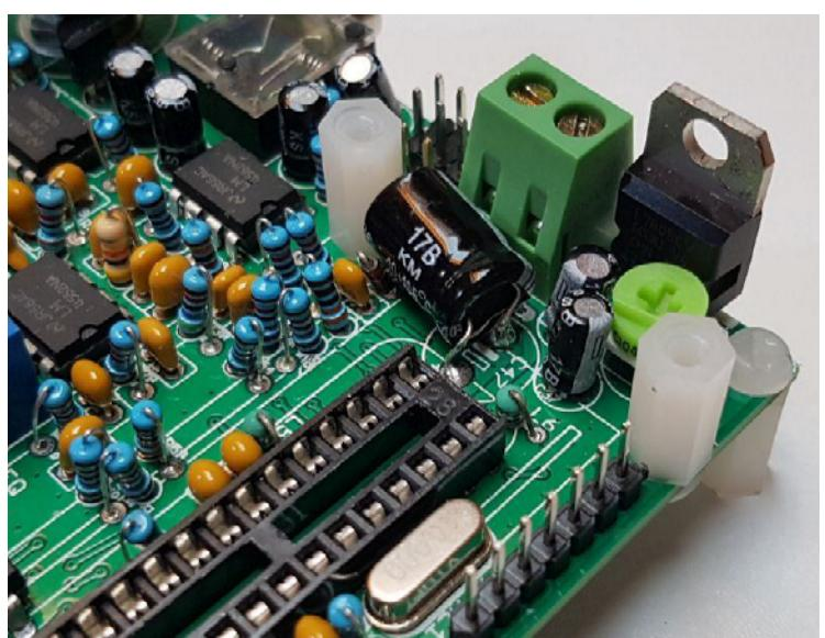
右の写真を参照してください。コンデンサーが適当な位置に入ったら、いつものようにリード線をはんだ付けしてください。
