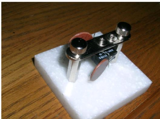
ミニステーにマイクロスイッチを取り付けます。ステーの穴は3mmですが使用するビスは2mmです。マイクロスイッチの取り付け穴も2mmです。取り付けの際は、ステーの穴に対するビスのあそびを使って、位置の微調整を行います。取り付けの上下にはワッシャーを必ず使いましょう。
