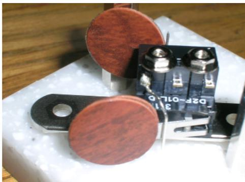
マイクロスイッチの残りの端子NC（ノーマルクローズ）を使って、レバーの開き止めを作ります。この端子に適当な長さの導線（抵抗のリード線など）を半田付けし、もう一方のマイクロスイッチのレバーの開き止めとします。ある一定のところでレバーが留まっていることで、操作がやりやすくなります。
