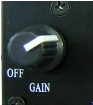
左側にあるこのボリュームは反時計回りに回しきるとスイッチが切れます。時計回りに回すとスイッチが入り、音量が増加します。(ノブをあまり回さずスイッチを入れただけの状態でも結構な音量です。改善の余地がありそうです。)
